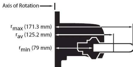
水平ロータ：チタニウム製バケット
